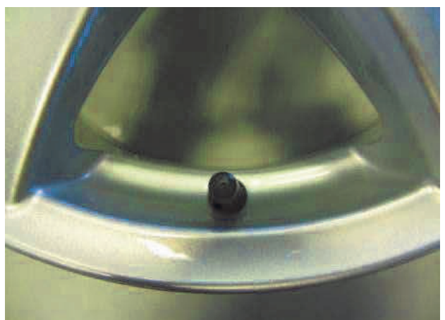
Bild 12. Keine nennenswerte Korrosionserscheinungen
