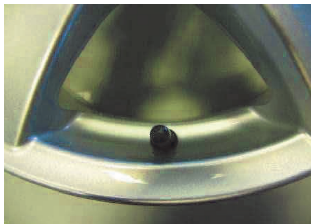
Bild 18. Keine nennenswerte Korrosionserscheinungen
