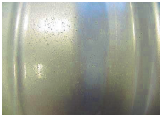
Bild 10. Steinschlagprüfung nach 192 h NSS Test (Felgenbett)
