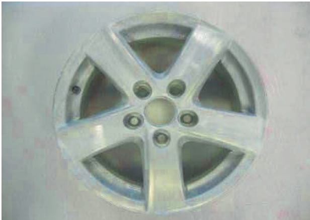
Bild 19. Umlaufbiegeprüfung bei 75% der maximalen Seitenkraft
