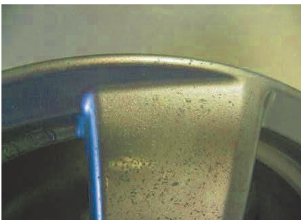
Bild 5. Steinschlagprüfung vorher NSS Test (Sichtseite)
