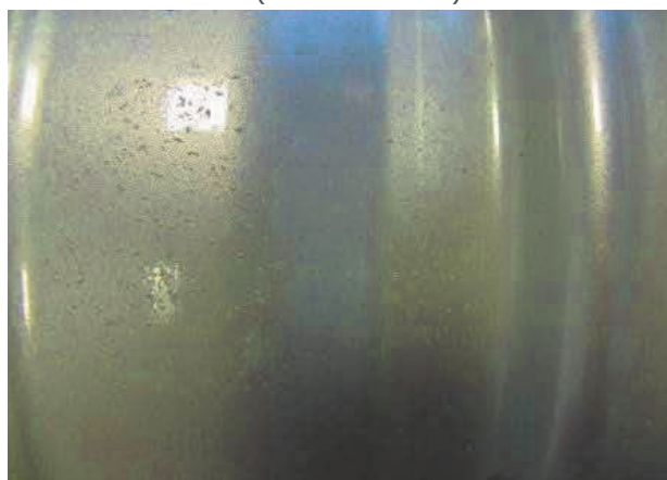
Bild 16. Steinschlagprüfung nach 384 h NSS Test (Felgenbett)
