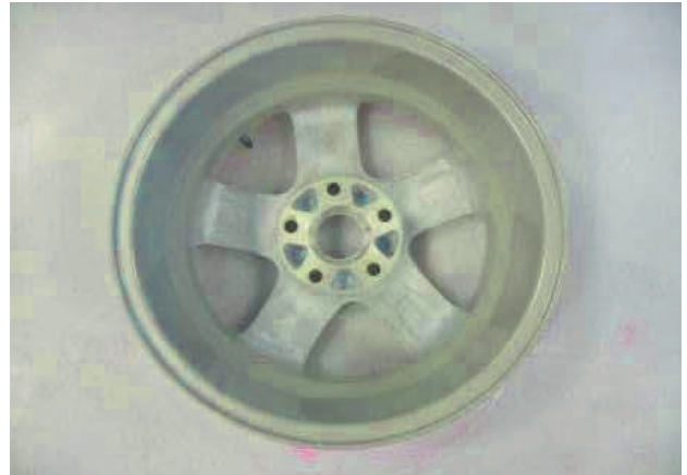
Bild 20. Umlaufbiegeprüfung bei 75% der maximalen Seitenkraft
