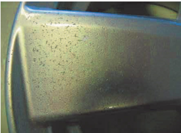
Bild 9. Steinschlagprüfung nach 192 h NSS Test (Sichtseite)
